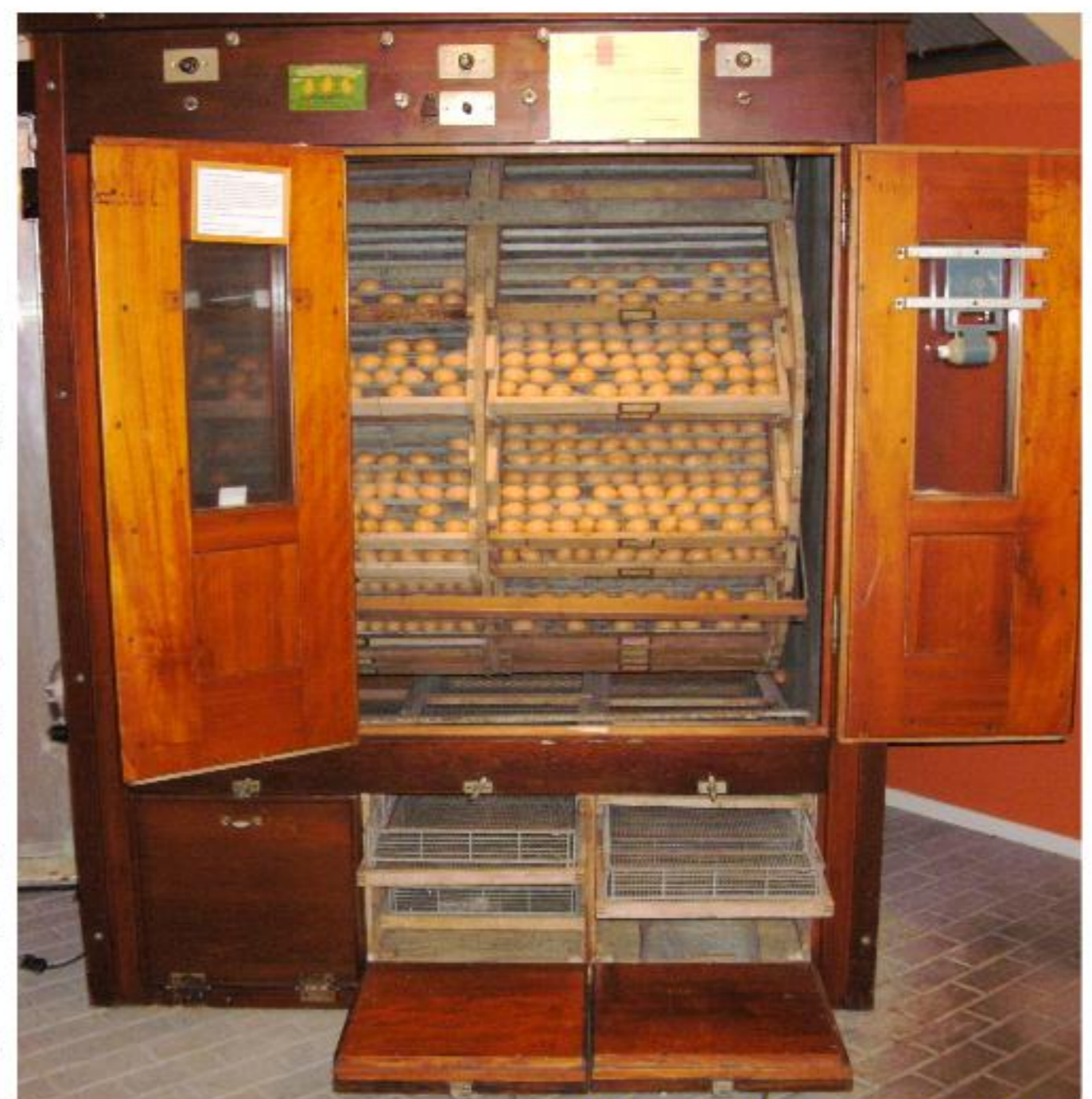
Waar ze later mee werkten: Econoom broedmachines met capaciteiten van 4.000 tot 10.000 broedeieren.
