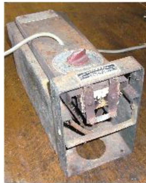
met deze elektrische snavelbrander (antiek model) ...
