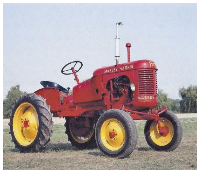
De motor van de Pony was een watergekoelde viercilinder van 1000 cc die 10,4 pk leverde.
